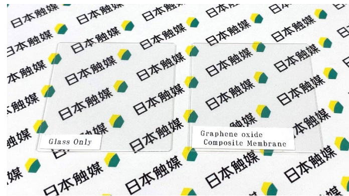
図 4：ガラス上の酸化グラフェン複合膜（波長 600 nm の光透過率 99%以上）
